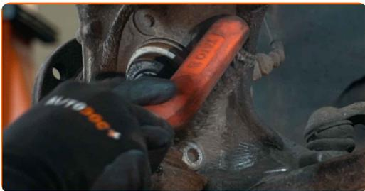
**36** Dévissez le support du roulement de moyeu. Servez vous de la douille XZN n°12. Utilisez une clé à cliquet.
