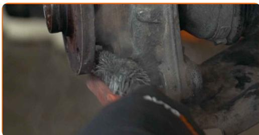
**28** Nettoyez les fixations assurant la connexion entre le joint à rotule et le bras de contrôle de suspension. Utilisez une brosse métallique. Servez vous de l'aérosol WD-40.
