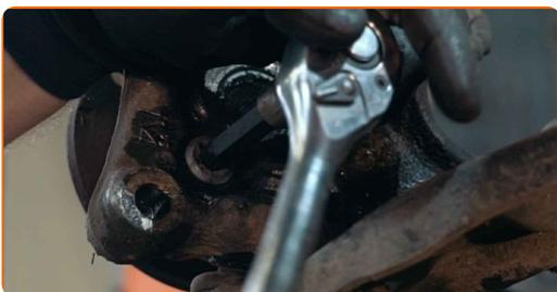
**37** Retirez le moyeu et le roulement puisqu'ils forment un bloc hermétique.
