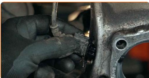
**42** Vissez la fixation reliant le capteur ABS à la fusée d'essieu. Utilisez la clé HEX n° H5. Utilisez une clé dynamométrique. Serrez-le jusqu'à 7 Nm.
