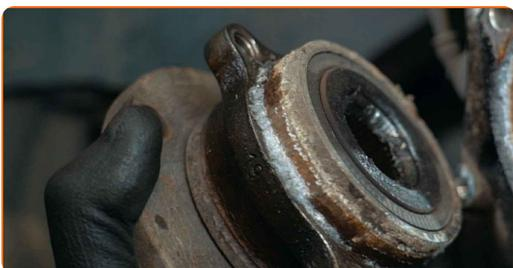
**38** Dévissez la fixation du capteur ABS. Utilisez la clé HEX n° H5. Utilisez une clé à cliquet.
