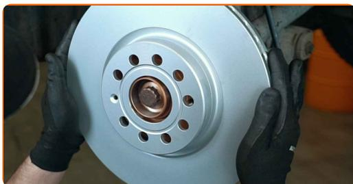
**58** Serrez l'attache du disque de frein. Utilisez la mèche Torx T30. Utilisez une clé dynamométrique. Serrez-le jusqu'à 4 Nm.
