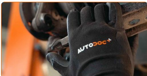
**31** Détachez l'arbre de transmission de la fusée d'essieu.
