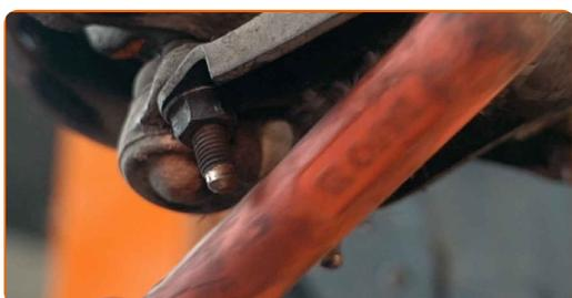
**29** Dévissez les fixations qui lient le joint à rotule au bras de contrôle de suspension. Utilisez une douille n° 16. Utilisez une clé à cliquet.
