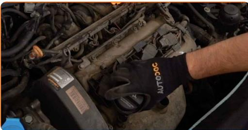
8 Recouvrez l'orifice de remplissage d'huile avec un chiffon microfibre pour empêcher que des particules n'entrent dans le système.
