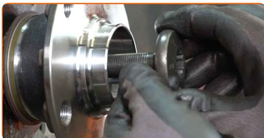
**27** Serrez le moyeu. Servez vous de la douille XZN n°18. Utilisez une clé dynamométrique. Serrez-le jusqu'à 180 Nm.
