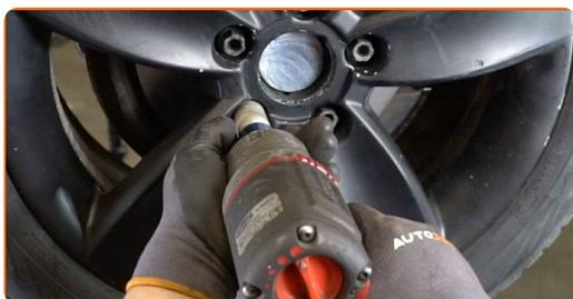
**49** Abaissez la voiture et serrez les boulons de roue en ordre croisé. Servez-vous d'une douille à choc pour roue N°17. Utilisez une clé dynamométrique. Serrez-le jusqu'à 120 Nm.
