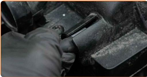
**15** Raccordez le tuyau de reniflard du carter au boîtier du filtre à air.
