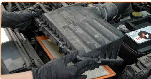
**7** Retirez l'élément filtrant du compartiment du filtre.
