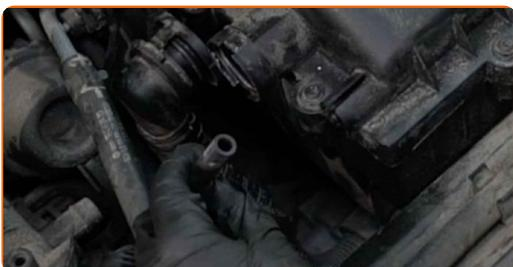
**5** Desserrez les trois vis de fixation du couvercle de filtre à air. Utilisez la mèche Torx T25. Utilisez une clé à cliquet.
