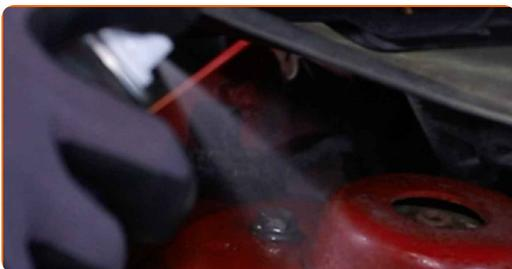
**8** Desserrez les fixations supérieures de la jambe de suspension. Utilisez une douille n° 13. Utilisez une clé à cliquet.
