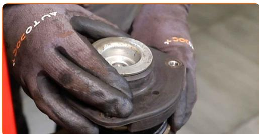
**48** Serrez l'écrou de l'entretoise d'amortisseur due la tige de piston. Utilisez une douille pour écrou de jambe de suspension de 21 mm. Utilisez la clé HEX n° H6. Utilisez une clé dynamométrique. Serrez-le jusqu'à 60 Nm.
