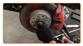
Dévissez les fixations qui lient le joint à rotule au bras de contrôle de suspension. Utilisez une douille n° 16. Utilisez une clé à cliquet.
