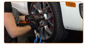
Desserrez le boulon du moyeu de roue. Servez-vous d'une douille 12 pans N°24. Utilisez un porte-taraud.
