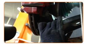
Serrez l'écrou de fixation du joint rotule. Utilisez une douille n° 16. Utilisez une clé dynamométrique. Serrez-le jusqu'à 60 Nm.
