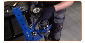
Installez la nouvelle coupelle, le manchon et la butée de suspension sur l'amortisseur.
