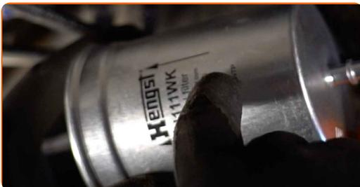
Remplacement : filtre à carburant – VW Jetta Mk1 (16). AUTODOC recommande :
