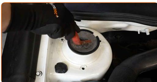
**4** Dévissez la fixation supérieure du support d'amortisseur. Utilisez la clé HEX n° H6. Utilisez une douille n° 21. Utilisez une clé à cliquet.
