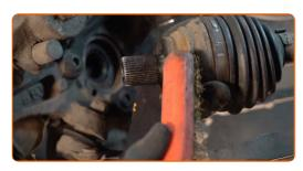
Montez l'arbre de transmission sur le moyeu de roue.
