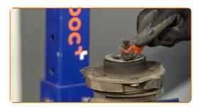
Retirez l'écrou de la tige de piston de l'entretoise. Utilisez la clé HEX n° H6. Utilisez une douille n° 21. Utilisez une clé à cliquet.
