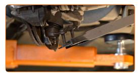
Dévissez les fixations qui lient l'arbre de transmission au moyeu de roue. Utilisez une douille n° 27.
