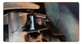
Dévissez la fixation inférieure assurant la connexion entre la jambe d'amortisseur et le porte-fusée. Utilisez une douille n° 18. Servez vous de la douille XZN n°12. Utilisez une clé à cliquet. Utilisez un porte-taraud.
