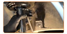
Serrez la fixation reliant la biellette à l'amortisseur. Utilisez une douille n° 18. Utilisez une clé mixte de No.17. Utilisez une clé dynamométrique. Serrez-le jusqu'à 60 Nm.
