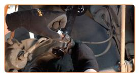
Serrez les fixations inférieures qui relient l'amortisseur à la fusée d'essieu. Utilisez une douille n° 18. Servez vous de la douille XZN n°12. Utilisez une clé à cliquet.
