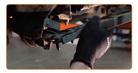
Serrez l'attache du joint rotule. Utilisez une douille n° 16. Utilisez une clé dynamométrique. Serrez-le jusqu'à 60 Nm.
