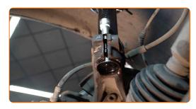
Installez l'écrou de fixation.
