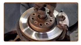
Retirez l'écrou de fixation.
