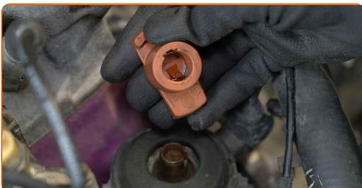
Remplacement : doigt d'allumeur – VW LT 28-35 I Camion à Plateau / Châssis (281-363). Les professionnels recommandent :
