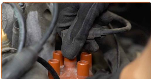
Remplacement : doigt d'allumeur – VW LT 28-35 | Camion à Plateau / Châssis (281-363). Conseil d'AUTODOC :
