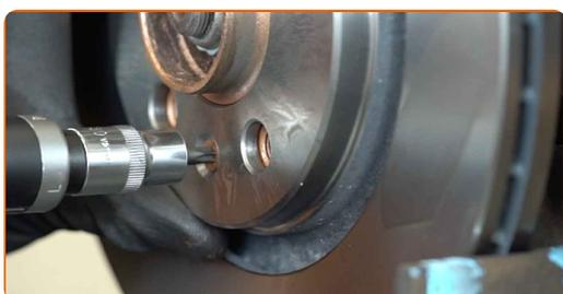
**17** Nettoyez la graisse anti-corrosion du nouveau disque de frein. Servez-vous d'un nettoyant pour freins.
