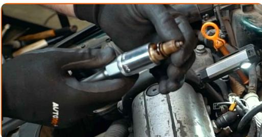
**10** Appliquez une fine couche d'antigrippant à haute température sur les fils des nouvelles bougies d'allumage.
