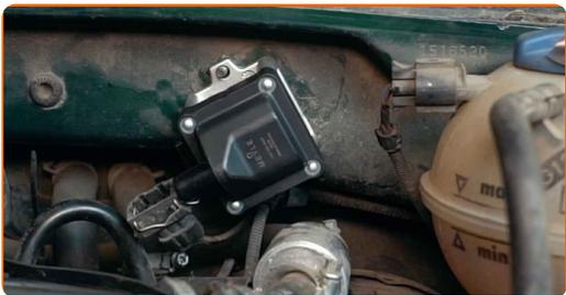
**10** Serrez l'attache de la bobine d'allumage. Utilisez une douille n° 10. Utilisez une clé dynamométrique. Serrez-le jusqu'à 7 Nm.
