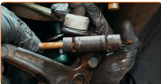
**46** Serrez les attaches du bras supérieur. Utilisez une clé mixte de No.16 Utilisez une douille n° 16. Utilisez une clé dynamométrique. Serrez-le jusqu'à 40 Nm.
