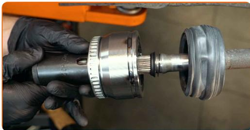
**39** Déplacez la bague intérieure du joint homocinétique d'un côté à l'autre pour la roder.
