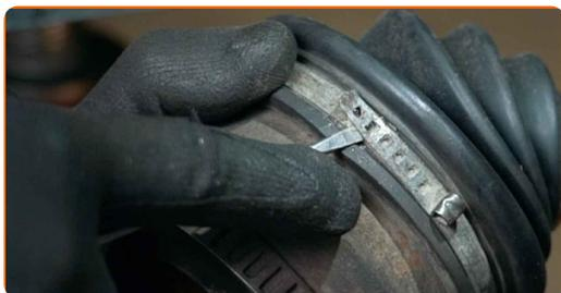
**21** Installez le boulon de l'arbre de transmission et serrez-le. Utilisez la clé HEX n° H14. Utilisez une clé à cliquet.
