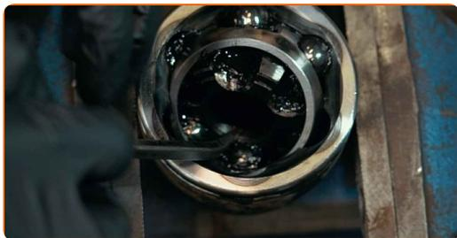
**29** Détachez le siège de montage du joint homocinétique. Servez-vous d'un aérosol nettoyant multi-usages.
