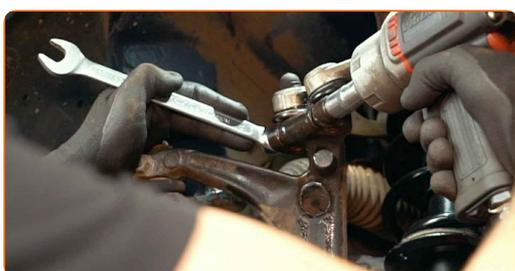
**16** Retirez l'écrou de fixation.
