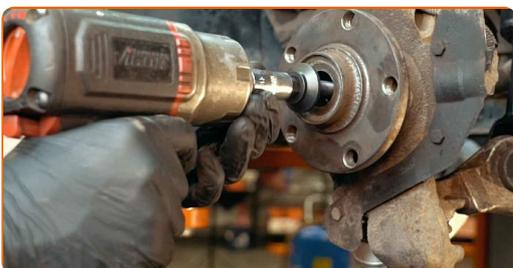
**48** Nettoyez le moyeu. Utilisez une brosse métallique. Traitez la surface de contact. Utilisez de la graisse au cuivre.
