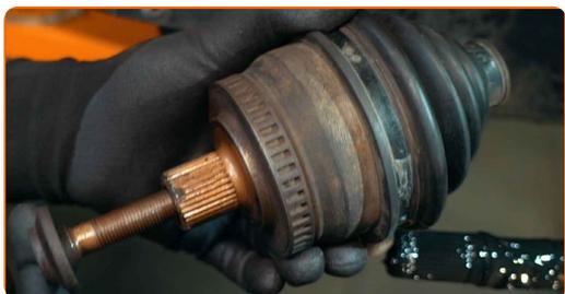
**23** Retirez l'écrou de fixation. Utilisez la clé HEX n° H14. Utilisez une clé à cliquet.
