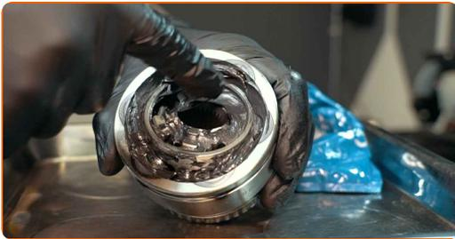
**35** Déplacez la bague intérieure du joint homocinétique d'un côté à l'autre pour la roder.
