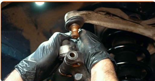
**45** Installez l'écrou de fixation.
