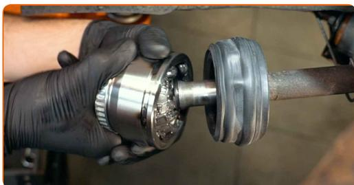
**40** Nettoyez les cannelures de joint de l'arbre de transmission. Servez-vous d'un aérosol nettoyant multi-usages.
