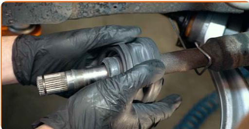
**37** Installez le circlip du joint homocinétique.
