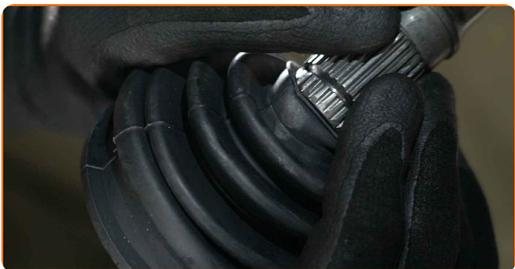
**33** Installez le circlip du joint homocinétique.
