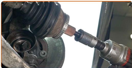
**26** Dévissez les fixations qui lient l'arbre de transmission au moyeu de roue.
