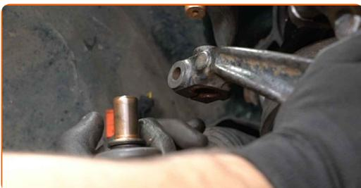
**21** Retirez l'écrou de fixation. Utilisez une douille n° 27.
