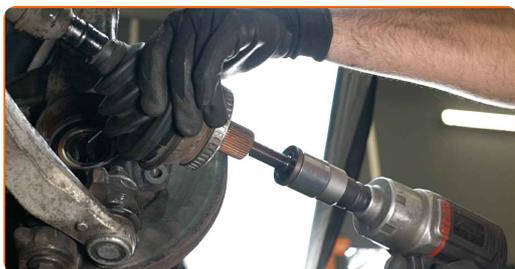
**27** Retirez l'écrou de fixation.
