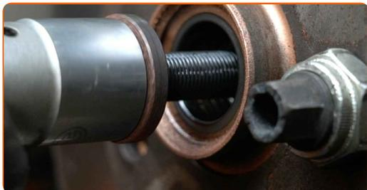
**22** Détachez l'arbre de transmission de la fusée d'essieu.
