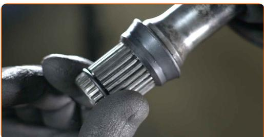
**34** Remplissez le joint homocinétique avec la graisse fournie dans le kit.
