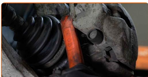
**9** Dévissez l'attache du support d'étrier. Utilisez une douille n° 17. Utilisez une clé à cliquet. Utilisez un porte-taraud.
