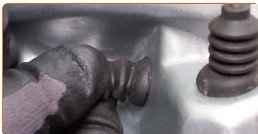
**43** Appliquez du produit sur le connecteur du module de la vitre électrique. Utilisez de la graisse diélectrique.
