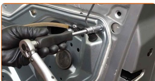
**54** Attachez le faisceau de câbles de la vitre électrique.
