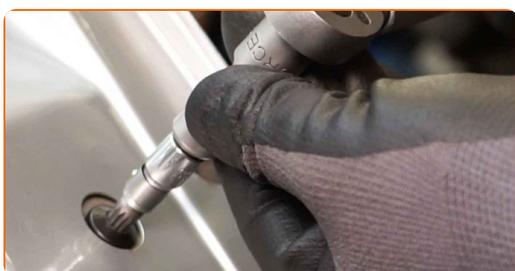
**53** Serrez les fixations du panneau de la portière. Utilisez une douille n° 10. Utilisez une clé dynamométrique. Serrez-le jusqu'à 8 Nm.
