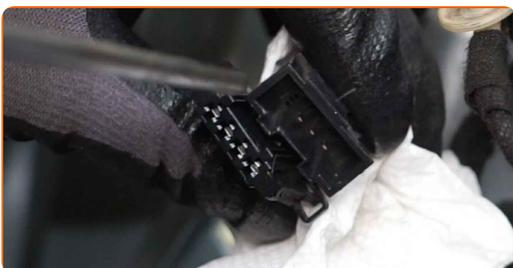
**47** Appliquez du produit sur le connecteur du module de commutateur de la vitre électrique. Utilisez de la graisse diélectrique.
