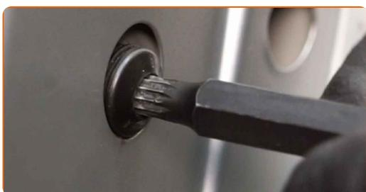
**52** Serrez les fixations de la serrure de la portière. Servez vous de la douille XZN n°8. Utilisez une clé dynamométrique. Serrez-le jusqu'à 20 Nm.
