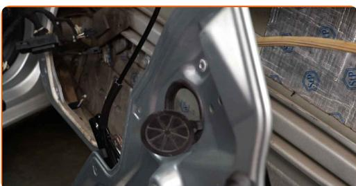
**39** Appliquez du produit sur le connecteur de la serrure de la portière. Utilisez de la graisse diélectrique.
