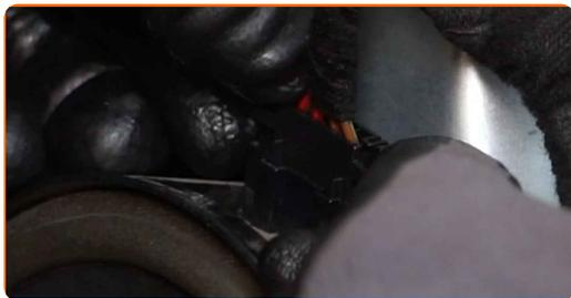
**50** Appliquez du produit sur le connecteur de l'ampoule. Utilisez de la graisse diélectrique.
