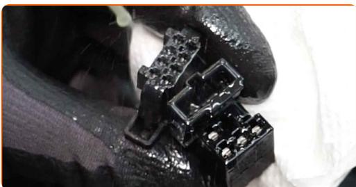
**46** Appliquez du produit sur le connecteur du commutateur de la vitre électrique. Utilisez de la graisse diélectrique.
