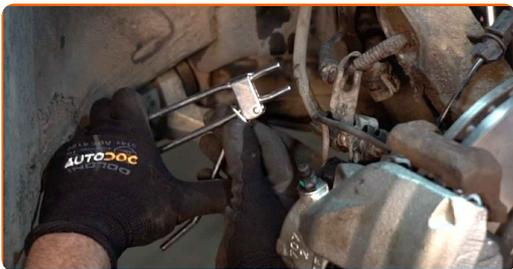
**29** Connectez le capteur électrique d'ABS. Connectez le connecteur du capteur d'usure de la plaquette de frein.
