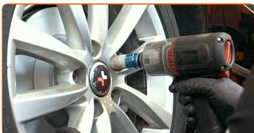
**38** Abaissez la voiture et serrez les boulons de roue en ordre croisé. Servez-vous d'une douille à choc pour roue N°17. Utilisez une clé dynamométrique. Serrez-le jusqu'à 120 Nm.
