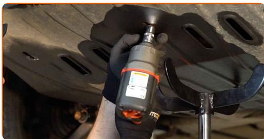
**5** Retirez le carénage sous moteur.
