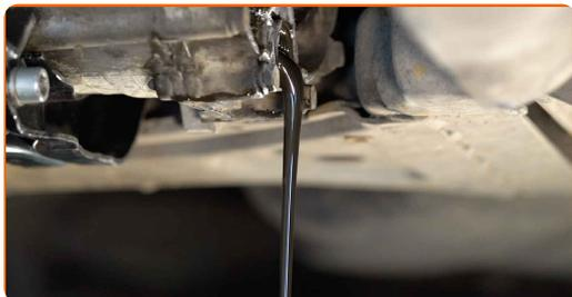
Remplacement : huile pour boîte de vitesses manuelle – VW Passat B2 3/5 portes (32B). Les professionnels recommandent :
