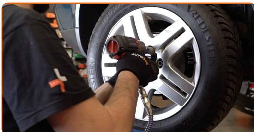
**20** Abaissez la voiture et serrez les boulons de roue en ordre croisé. Utilisez une clé dynamométrique. Serrez-le jusqu'à 120 Nm.
