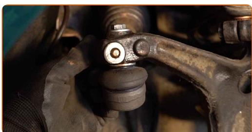
**22** Vissez l'écrou de fixation reliant l'embout de biellette à la fusée d'essieu. Utilisez une douille n° 15. Utilisez une clé à cliquet.
