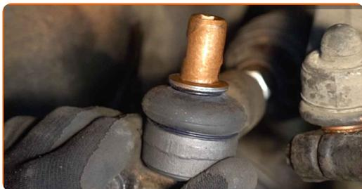
**19** Connectez l'extrémité du tirant à la fusée d'essieu.
