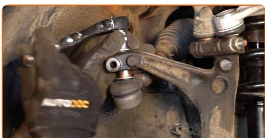
**21** Installez l'écrou de fixation.
