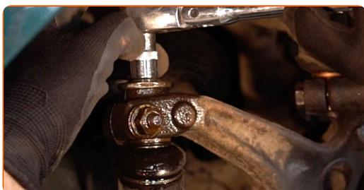
**8** Dévissez l'écrou d'attache d'extrémité à la fusée d'essieu. Utilisez une douille n° 15. Utilisez une clé à cliquet.
