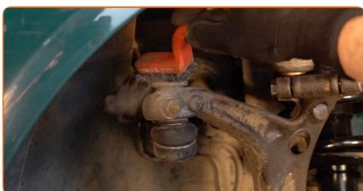
**7** Dévissez l'écrou d'attache d'extrémité à la fusée d'essieu. Utilisez une douille n° 13. Utilisez une clé à cliquet.
