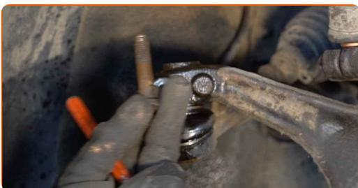
**10** Déconnectez l'extrémité de la barre de la fusée d'essieu. Servez-vous d'un burin plat pour l'usinage des métaux. Servez-vous d'un marteau.
