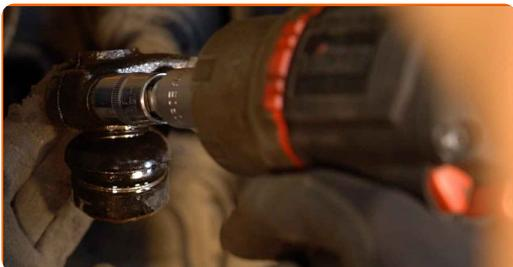
**9** Retirez l'écrou de fixation.
