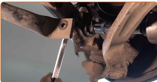
**22** Retirez l'écrou de fixation.
