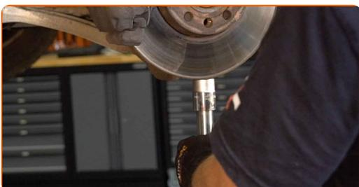
**Remplacement : jambe de suspension – VW Passat B5 Break (3B5). Conseil :**
