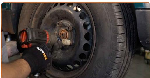
**73** Abaissez la voiture et serrez les boulons de roue en ordre croisé. Utilisez une clé dynamométrique. Serrez-le jusqu'à 120 Nm.
