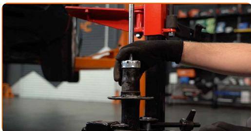
Remplacement : jambe de suspension – VW Passat B5 Break (3B5). Les professionnels recommandent :
