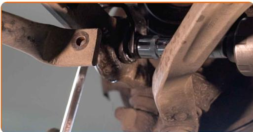
**22** Retirez l'écrou de fixation.
