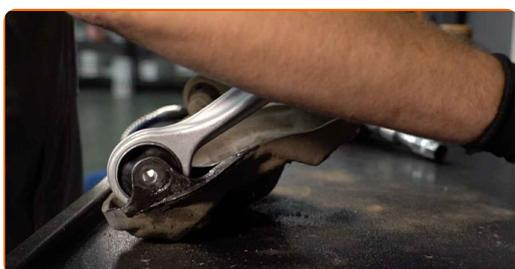
Remplacement : bras supérieur avant – VW Passat B5 Break (3B5). Les experts d'AUTODOC recommandent :
