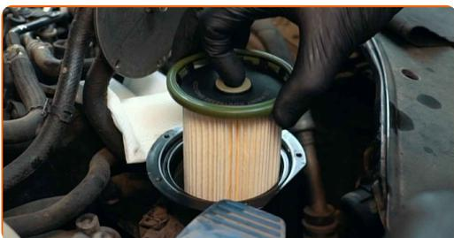
Remplacement : filtre à carburant – VW Passat B7 Alltrack (365). Conseil :
