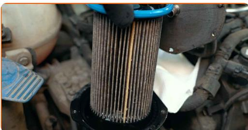
Remplacement : filtre à carburant – VW Passat B7 Alltrack (365). AUTODOC recommande :
