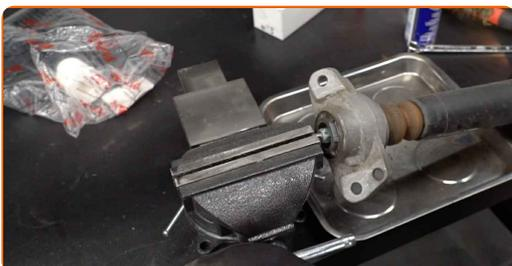
**15** Retirez l'attache de la tige du piston de l'amortisseur. Utilisez une clé mixte de No.14.
