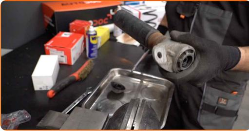
**17** Installez la nouvelle coupelle, le manchon et la butée de suspension sur l'amortisseur.
