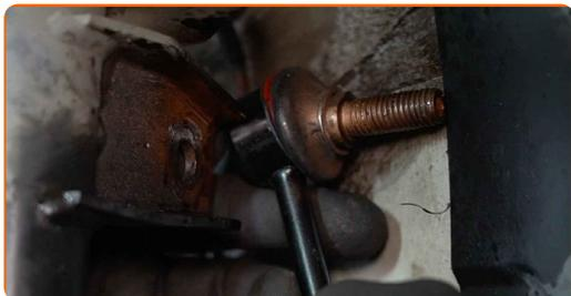
**10** Retirez l'écrou de fixation.
