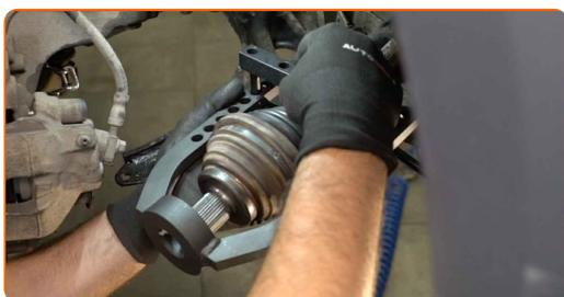
**20** Installez le boulon de l'arbre de transmission et serrez-le. Utilisez une douille n° 27. Utilisez une clé à cliquet.
