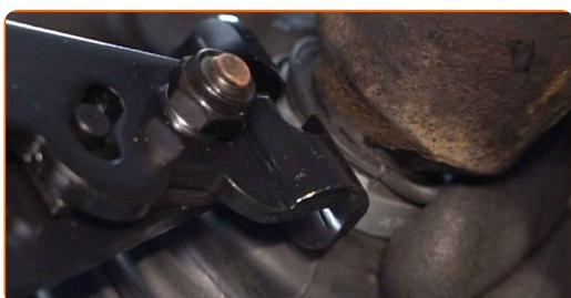
**35** Appliquez du produit sur les cannelures de joint de l'arbre de transmission. Utilisez de la graisse au cuivre.
