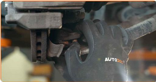
**59** Serrez les fixations reliant le joint à rotule au bras de commande. Utilisez une douille n° 16. Utilisez une clé dynamométrique. Serrez-le jusqu'à 60 Nm.
