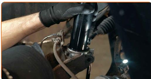
**52** Installez l'écrou de fixation.
