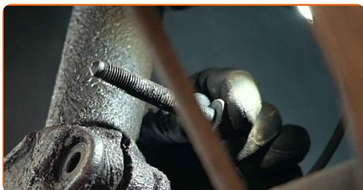
**27** Relâchez la fixation inférieure assurant la connexion entre la jambe d'amortisseur et le porte-fusée. Servez-vous d'un burin plat pour l'usinage des métaux. Servez-vous d'un marteau.
