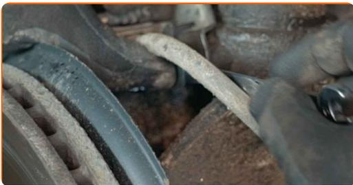
**18** Desserrez la fixation de l'arbre de transmission. Utilisez une douille n° 27. Utilisez une clé à cliquet.
