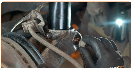
**53** Vissez la fixation qui relie la jambe d'amortisseur à la fusée d'essieu. Utilisez une douille n° 18. Servez vous de la douille XZN n°14. Utilisez une clé à cliquet.
