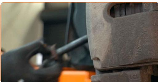
**20** Dévissez la fixation inférieure assurant la connexion entre la jambe d'amortisseur et le porte-fusée. Utilisez une douille n° 18. Servez vous de la douille XZN n°14. Utilisez une clé à cliquet.
