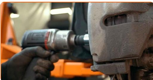
**19** Retirez l'écrou de fixation.
