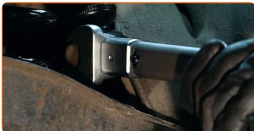
**39** Serrez la fixation du bras inférieur. Utilisez une clé mixte de No.18 Utilisez une douille n° 18. Utilisez une clé dynamométrique. Serrez-le jusqu'à 90 Nm.+90°
