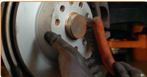
**43** Appliquez du produit sur la zone de contact entre le disque de frein et la jante. Utilisez de la graisse au cuivre.
