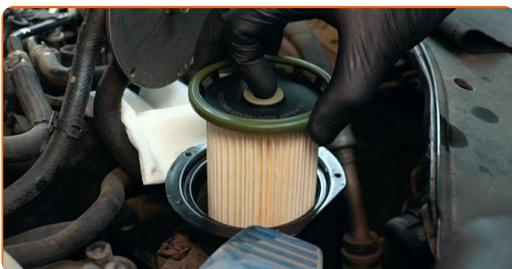
Remplacement : filtre à carburant – VW Passat NMS (A32, A33). Conseil :
