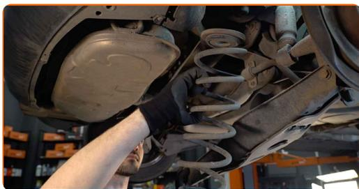
13 Dévissez les fixations qui relient le bras de suspension à la fusée d'essieu arrière. Utilisez une clé mixte de No.18. Utilisez une douille n° 18. Utilisez une clé à cliquet.
