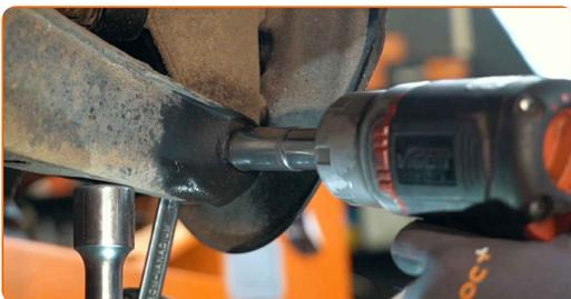
**13** Retirez l'écrou de fixation.
