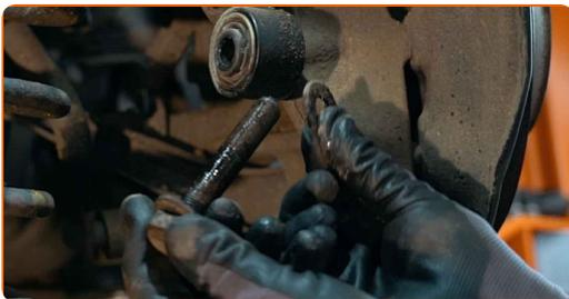
**16** Dévissez l'attache supérieure de l'amortisseur. Utilisez une douille n° 16. Utilisez une clé à cliquet.
