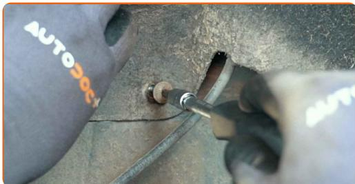
**33** Installez l'écrou de fixation.
