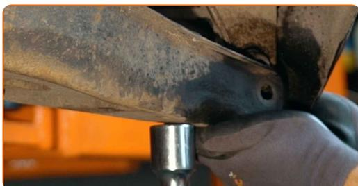
**36** Installez l'écrou de fixation.
