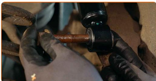
**34** Vissez la fixation inférieure de l'amortisseur. Utilisez une douille n° 21. Utilisez une clé à cliquet.
