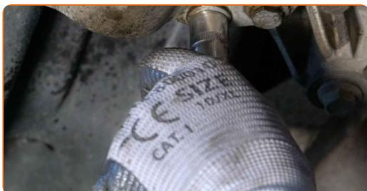
**12** Retirez la fixation arrière du bras de suspension (2 pièces).
