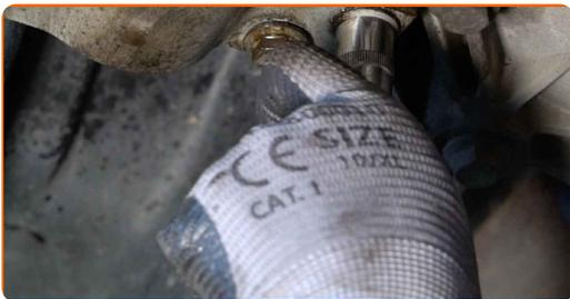
**13** Dévissez les fixations qui lient le joint à rotule au bras de contrôle de suspension. Utilisez une douille n° 16. Utilisez un porte-taraut.
