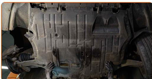
**33** Serrez les fixations du carénage sous moteur. Utilisez une douille n° 13. Utilisez la mèche Torx T25. Utilisez une clé à cliquet.
