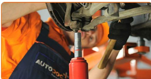
**37** Serrez le boulon de fixation reliant la fourchette d'amortisseur au bras de suspension inférieur. Utilisez une clé mixte de No.18 Utilisez une douille n° 18. Utilisez une clé dynamométrique. Serrez-le jusqu'à 90 Nm.
