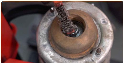
**20** Retirez l'écrou de la tige de piston de l'entretoise. Utilisez une douille n° 19. Utilisez une clé à cliquet.
