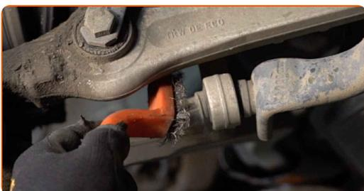
**7** Dévissez le boulon de fixation reliant la jambe d'amortisseur au bras de suspension inférieur. Utilisez une clé mixte de No.18 Utilisez une douille n° 18. Utilisez une clé à cliquet.
