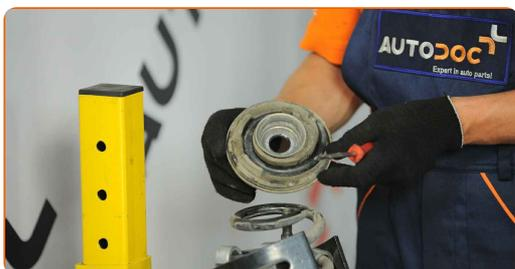
Remplacement : coupelle d'amortisseur – VW PASSAT Variant (3B5). Les professionnels recommandent :
