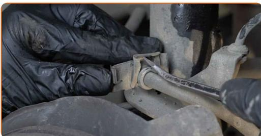
**19** Débranchez les fils du capteur d'ABS.
