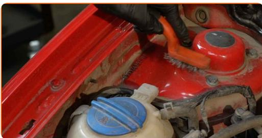
**4** Dévissez la fixation supérieure du support d'amortisseur. Utilisez une douille n° 13. Utilisez une clé à cliquet.
