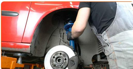
**46** Vissez l'attache supérieure du support de l'amortisseur Ne serrez pas trop.
