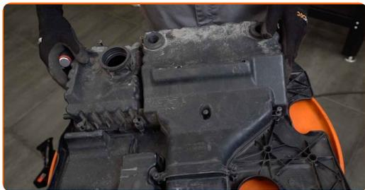
**12** Vissez les trois vis de fixation du couvercle de filtre à air. Servez-vous d'un tournevis Phillips.
