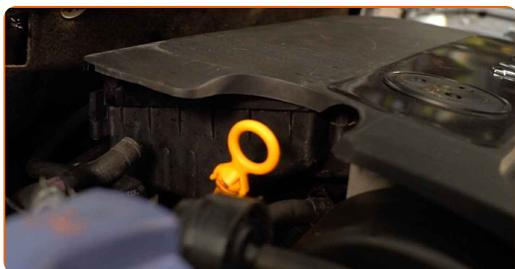
**4** Retirez le couvercle du moteur. Le compartiment du filtre à air est intégré au couvercle du moteur.
