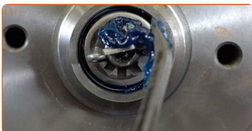
**29** Installez le bouchon de l'écrou du moyeu. Servez-vous d'un maillet en caoutchouc.
