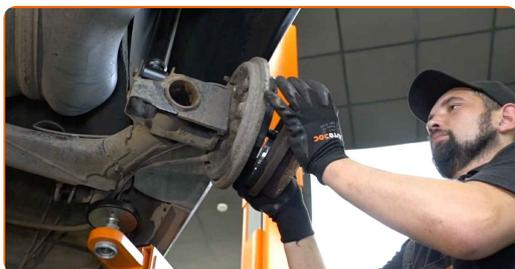
**Remplacement : roulement de roue – VW POLO (6N2). Conseil :**
