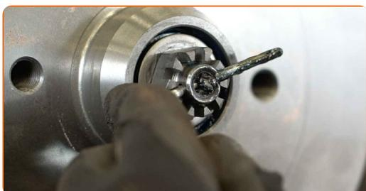
**28** Appliquez du produit sur l'écrou de moyeu de la roue. Servez-vous d'une graisse multi-usages.
