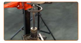
Retirez l'amortisseur usagé du compresseur à ressort hydraulique hélicoïdal.
