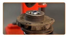
Serrez l'écrou de l'entretoise d'amortisseur due la tige de piston. Utilisez une douille n° 21. Utilisez la clé HEX n° H6. Utilisez une clé dynamométrique. Serrez-le jusqu'à 60 Nm.
