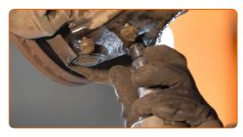
Serrez les fixations inférieures qui relient l'amortisseur à la fusée d'essieu. Utilisez une douille n° 18. Utilisez une clé dynamométrique. Serrez-le jusqu'à 60 Nm.+90°
