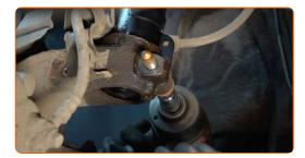
Vissez la fixation qui relie la jambe d'amortisseur à la fusée d'essieu. Utilisez une douille n° 18. Servez vous de la douille XZN n°12. Utilisez une clé à cliquet.
