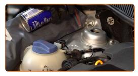
Devissez la fixation supérieure du support d'amortisseur. Utilisez une douille n° 13. Utilisez une clé à cliquet.
