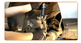
Installez l'écrou de fixation. Utilisez une douille n° 18.
