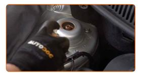
Vissez l'écrou de blocage du moyeu de roue. Servez-vous d'une douille 12 pans n°30. Utilisez une clé dynamométrique. Serrez-le jusqu'à 50 Nm.+45°
