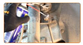
Dévissez l'écrou et retirez la barre stabilisatrice de l'entretoise de l'amortisseur. Utilisez une douille n° 16. Utilisez une clé à cliquet.
