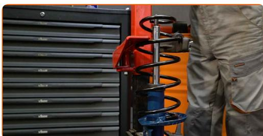
**41** Installez la coupelle, le manchon et la butée de suspension sur l'amortisseur.
