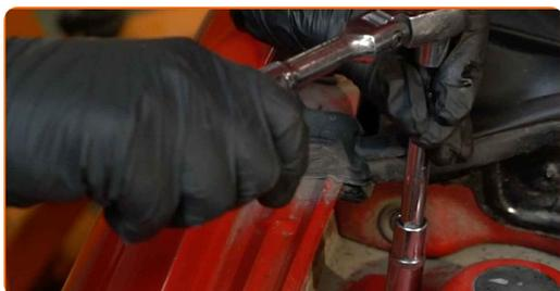
**5** Retirez le bouchon de protection du support d'amortisseur.
