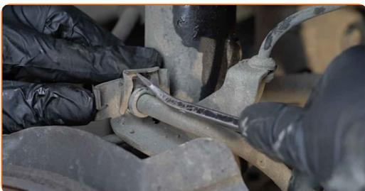
**18** Débranchez les fils du capteur d'ABS.
