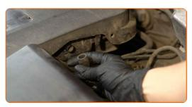
Retirez le couvercle du moteur. Le compartiment du filtre à air est intégré au couvercle du moteur.
