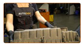
Vissez les trois vis de fixation du couvercle de filtre à air. Servez-vous d'un tournevis Phillips.
