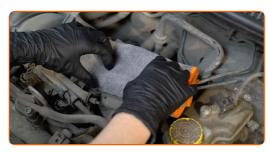
Desserrez les trois vis de fixation du couvercle de filtre à air. Servez-vous d'un tournevis Phillips.
