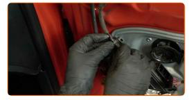
Fixez le connecteur de réglage du rétroviseur à la portière.
