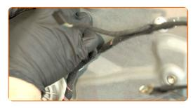
Détachez le faisceau de câble du panneau de protection de la porte. Utilisez un outil d'extraction de clips.
