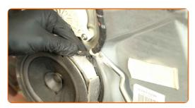
Détachez le connecteur de réglage du rétroviseur de l'unité de commande.
