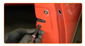
Détachez le connecteur de réglage du rétroviseur de la portière.
