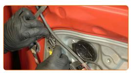
Détachez le faisceau de câble du panneau de protection de la porte. Utilisez un outil d'extraction de clips.
