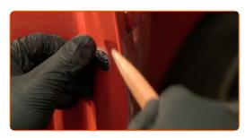
Dévissez la fixation de la poignée extérieure de la porte. Utilisez la mèche Torx T20. Utilisez une clé à cliquet.
