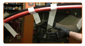
Abaissez la vitre de la fenêtre et installez-la sur son emplacement de montage dans le mécanisme de lève-vitre.
