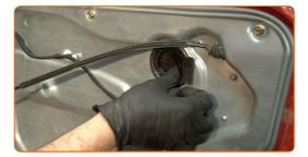
Branchez le connecteur de réglage du rétroviseur sur l'unité de commande.
