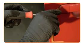
17 Retirez le câble de verrouillage de la poignée. Utilisez un tournevis plat.
