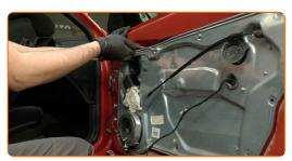
Serrez les fixations de la serrure de la portière. Servez vous de la douille XZN n°8. Utilisez une clé dynamométrique. Serrez-le jusqu'à 20 Nm.
