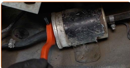
**9** Relâchez les colliers de fixation des tuyaux de filtre à carburant. Utilisez une douille n° 7. Utilisez une clé à cliquet.
