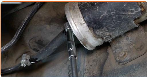
**10** Dévissez le support du filtre à carburant. Utilisez une douille n° 10. Utilisez une clé à cliquet.
