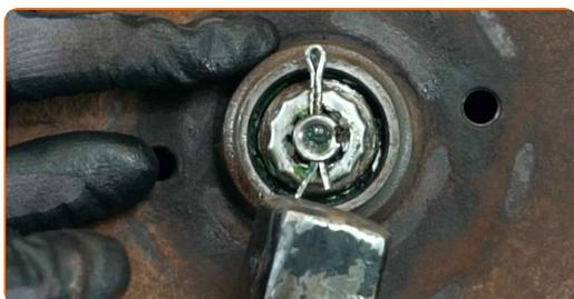
**11** Dévissez l'écrou de moyeu. Utilisez une douille n° 24. Utilisez une clé à cliquet.
