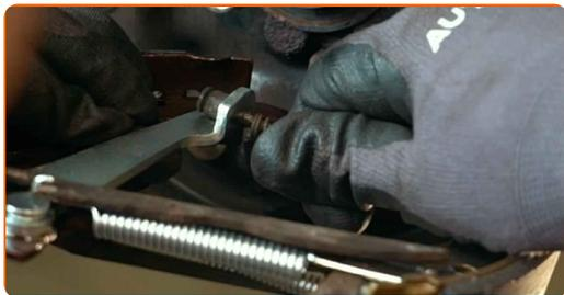
**25** Installez les plaquettes de frein sur le cylindre de frein sur son support, et sur le support de la plaque de support de frein.
