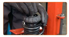
Serrez l'écrou de l'entretoise d'amortisseur due la tige de piston. Utilisez la clé HEX n° H6. Utilisez une douille n° 21. Utilisez une clé dynamométrique. Serrez-le jusqu'à 60 Nm.
