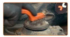
Devissez la fixation supérieure du support d'amortisseur. Utilisez la clé HEX n° H6. Utilisez une douille n° 21. Utilisez une clé à cliquet.
