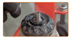
Retirez l'écrou de la tige de piston de l'entretoise. Utilisez la clé HEX n° H6. Utilisez une douille n° 21. Utilisez une clé à cliquet.
