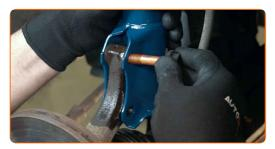
Vissez les fixations reliant la jambe de suspension à la fusée d'essieu. Utilisez une clé mixte de No.18 Utilisez une douille n° 18. Utilisez une clé à cliquet.
