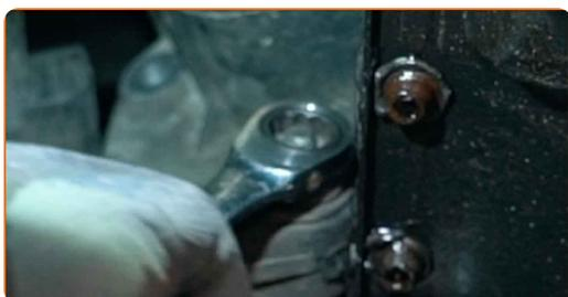
**33** Dévissez la fixation du câble de changement de vitesses. Utilisez une douille n° 13. Utilisez une clé à cliquet.
