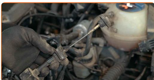
10 Débranchez le connecteur du faisceau de câbles du moteur.
