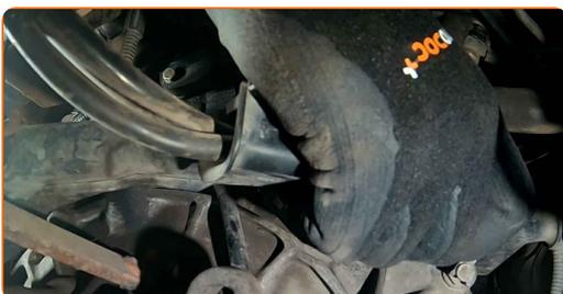
14 Dévissez les fixations du démarreur du moteur. Utilisez une douille n° 13. Utilisez une clé à cliquet.
