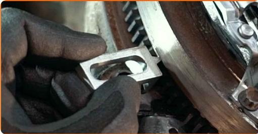
**60** Serrez les fixations de la plaque de pression. Servez-vous d'une douille 12 pans n°9. Utilisez une clé dynamométrique. Serrez-le jusqu'à 27 Nm.
