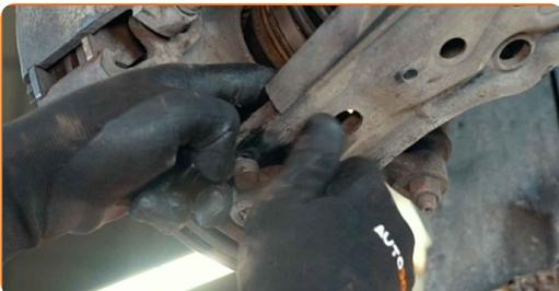
**92** Vissez la fixation reliant le joint à rotule au bras de commande. Utilisez une douille n° 13. Utilisez une clé à cliquet.
