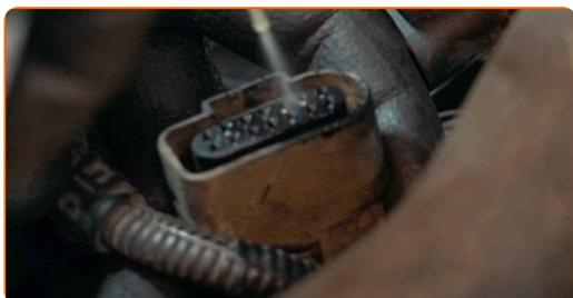
113 Branchez le connecteur du faisceau de câbles du moteur.
