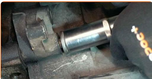
**68** Serrez les fixations qui relient la boîte de transmission au bloc-moteur. Utilisez une douille n° 18. Utilisez une clé dynamométrique. Serrez-le jusqu'à 64 Nm.
