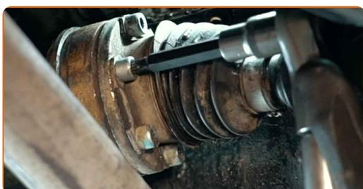
**94** Installez l'écrou de fixation.
