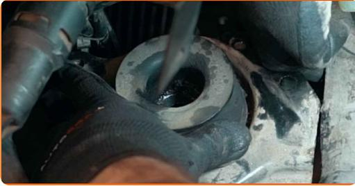
**73** Vissez les fixations qui relient le support de la boîte de vitesses à la carrosserie. Utilisez une douille n° 18. Utilisez une clé à cliquet.
