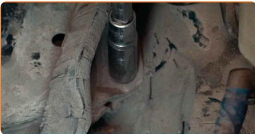
**75** Serrez les fixations qui relient le support de la boîte de vitesses à la boîte de vitesses. Utilisez une douille n° 18. Utilisez une clé dynamométrique. Serrez-le jusqu'à 69 Nm.
