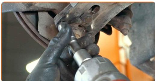
**93** Serrez les fixations du joint interne du demi-arbre de transmission. Servez vous de la douille XZN n°8. Utilisez une clé dynamométrique. Serrez-le jusqu'à 42 Nm.
