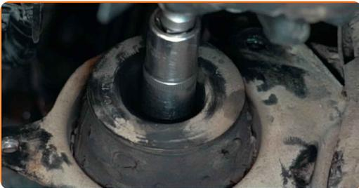
**74** Serrez les fixations qui relient le support de la boîte de vitesses à la carrosserie. Utilisez une douille n° 13. Utilisez une clé dynamométrique. Serrez-le jusqu'à 38 Nm.
