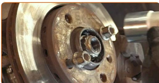
**95** Vissez l'écrou de l'essieu homocinétique. Utilisez une douille n° 30. Utilisez une clé à cliquet.
