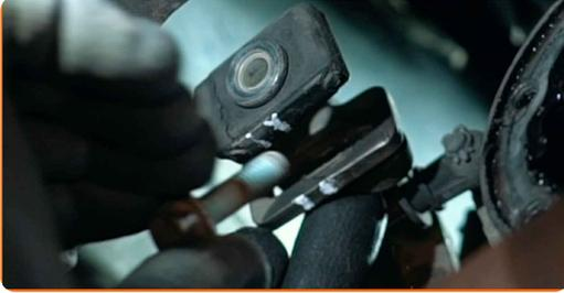
**34** Retirez le clip de retenue du câble de changement de vitesses. Utilisez un tournevis plat.
