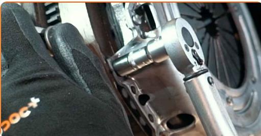
**61** Retirez l'outil de blocage du volant d'inertie.
