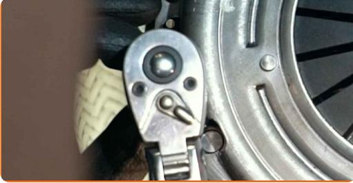
**59** Installez l'outil de blocage de volant moteur. Utilisez un kit d'outils pour embrayage.
