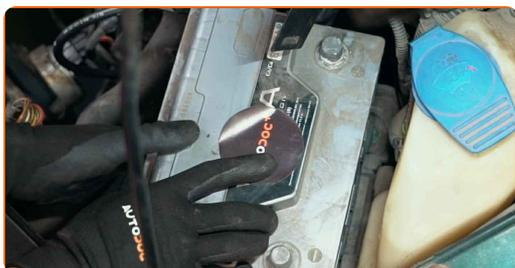
**118** Vissez la fixation de la batterie. Utilisez une douille n° 13. Utilisez une clé à cliquet.
