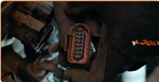
11 Détachez le faisceau de câbles du moteur.
