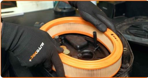
Remplacement : filtre à air – VW Polo III Variant (6V5). AUTODOC recommande :
