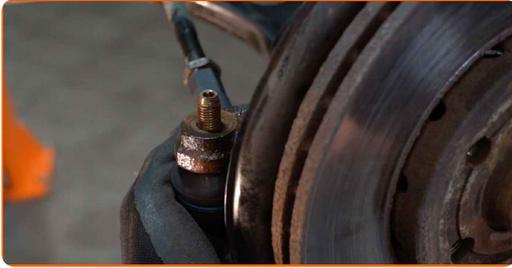
15 Vissez l'écrou de fixation reliant l'embout de biellette à la fusée d'essieu. Utilisez une clé mixte de No.19 Utilisez la clé HEX n° H6. Utilisez une clé à cliquet.
