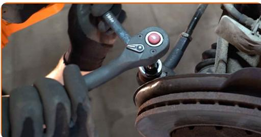
16 Serrez l'écrou de fixation reliant l'embout de biellette de direction à la fusée d'essieu. Utilisez une douille n° 19. Utilisez une clé dynamométrique. Serrez-le jusqu'à 20 Nm.+90°
