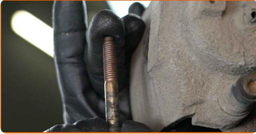
**19** Serrez les fixations de l'étrier de frein. Utilisez la clé HEX n° H6. Utilisez une clé dynamométrique. Serrez-le jusqu'à 25 Nm.
