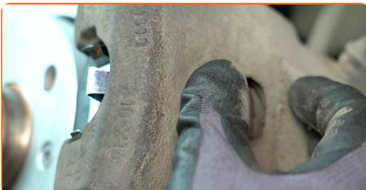
**18** Installez les boulons de fixation.
