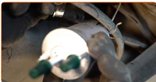
**13** Serrez les attaches du filtre à carburant. Servez-vous d'un tournevis Phillips.
