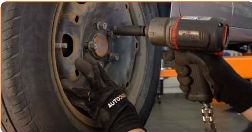
**34** Abaissez la voiture et serrez les boulons de roue en ordre croisé. Utilisez une clé dynamométrique. Serrez-le jusqu'à 120 Nm.
