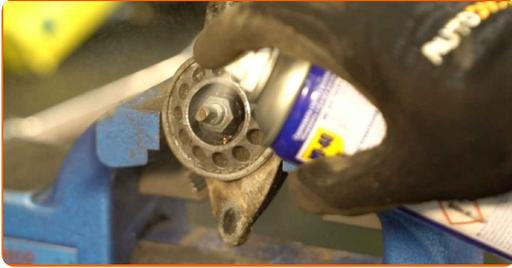
15 Retirez l'attache de la tige du piston de l'amortisseur. Utilisez une douille n° 15. Utilisez une clé à cliquet.
