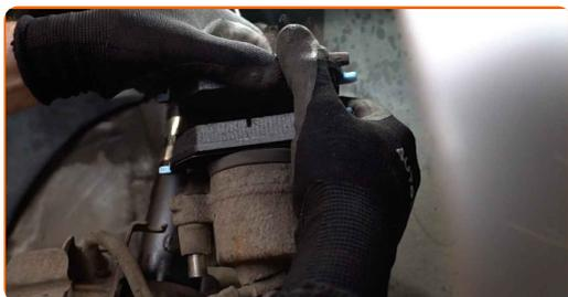
22 Installez l'étrier de frein et fixez-le. Utilisez la clé HEX n° H7. Utilisez une clé dynamométrique. Serrez-le jusqu'à 30 Nm.
